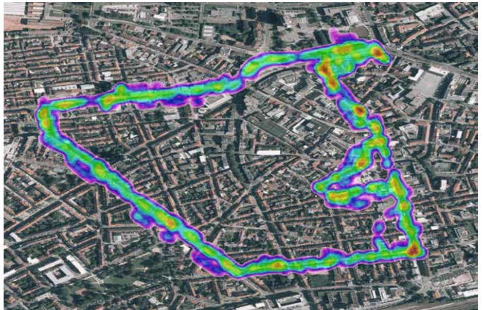
Abbildung 6: Potenzielle Gefahrenpunkte für Fahrradfahrer, identifiziert anhand des psychophysiologischen Monitorings – der „Stressmessung“ (CPE 2014)
