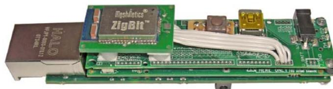
Abbildung 2: Embedded Device für standardisierte Messung und Übertragung von Umweltparametern.
